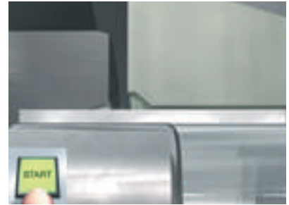
Después de comenzar el proceso, las mordazas sujetan el tubo y el punzón deconformado empieza a moverse hacia adelante
