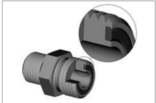
Fig. 1 – Vista seccionada de la ranura para junta tórica cautiva (CORG)
