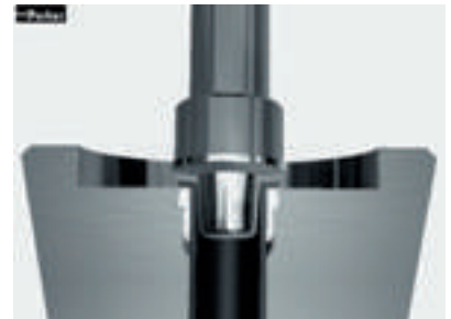
La superficie frontal se lamina y comprime continuamente. Desde el interior, la superficie del tubo se expande ligeramente para fijar la férula
