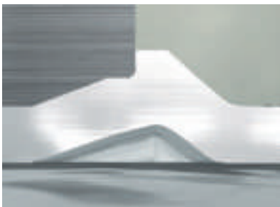
Tan pronto como el punzón en movimiento toca las mordazas, el proceso de conformado ha finalizado
