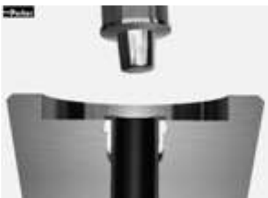
Tan pronto como se consigue el contorno de brida definido, cesa el movimiento orbital y se retira el punzón
