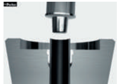
Después de comenzar el proceso, las mordazas sujetan el tubo y el punzón de embridar inicia el movimiento orbital y la carrera hacia delante
